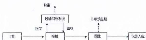
图 1 项目变更后的喷粉线工艺流程及产污节点
